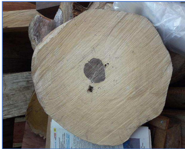
Figura 5. Muestra de rodaja de madera de Dalbergia retusa de 25 años producto de plantaciones forestales en El Salvador.
