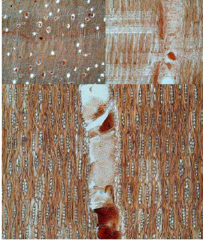
Figura 6. Madera de Cocobolo, siguiendo la manecilla del reloj: A. Corte transversal de madera, B. Corte radial, C. Corte tangencial. Fuente: Meyrat (2018).
