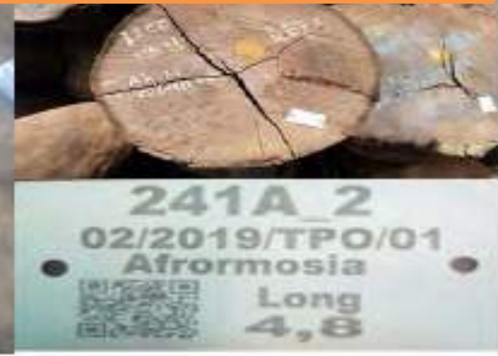
Photo plaque sécurisation du marquage dans les faces des grumes et billes
