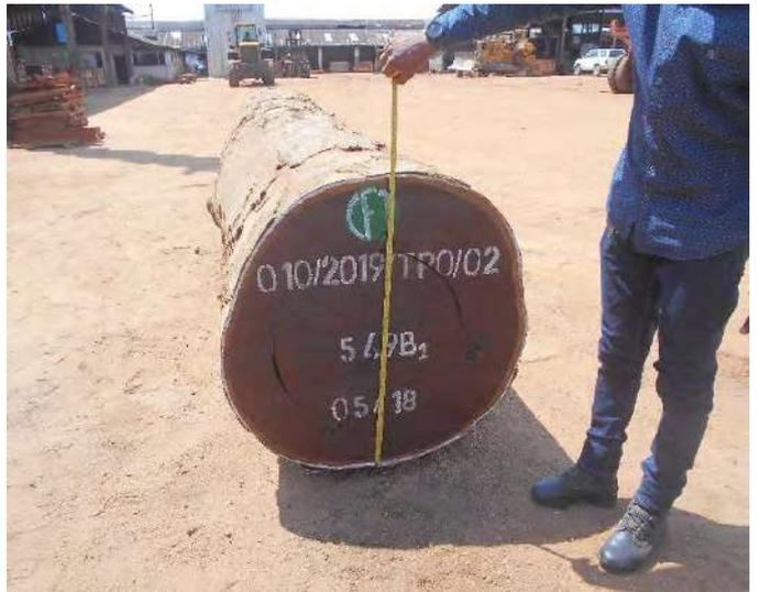
Prise de mesure de Diamètre A
