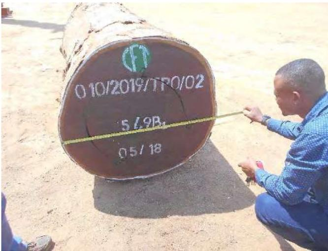
Prise de mesure de Diamètre B
