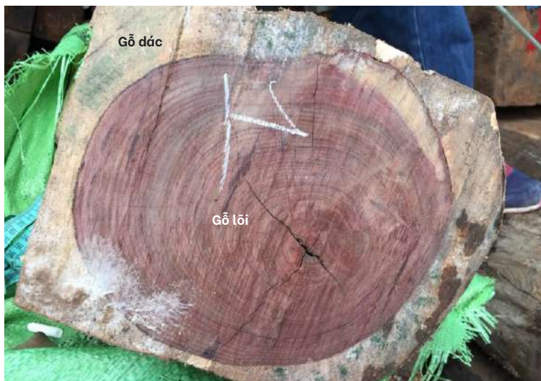
Hình 4.12. Gỗ dác và gỗ lõi Cẩm lai phân biệt về màu sắc (Ảnh: Đỗ Văn Bản)
