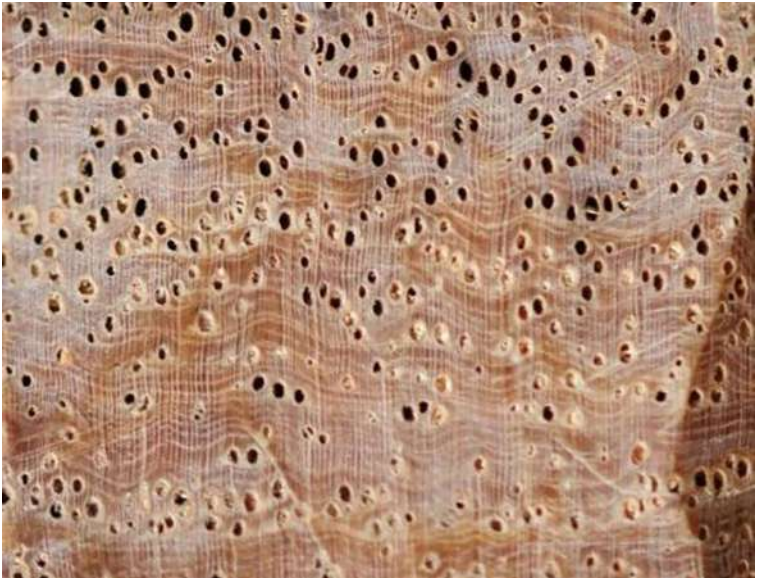
Hình 3.17. Mặt cắt ngang gỗ Trác (hướng dọc ảnh: hướng xuyên tâm hay hướng theo tia gỗ; hướng ngang ảnh: hướng tiếp tuyến). (Ảnh: Đỗ Văn Bản)
