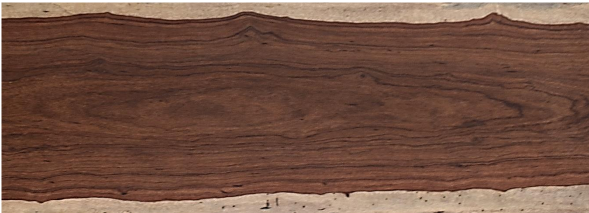
Fotografía 6. Vista longitudinal tangencial de la madera de P. yucatanum ; con vetado de arcos superpuestos y duramen color café-rojizo con líneas muy oscuras. Se observa el cambio abrupto de color entre la albura y el duramen.
